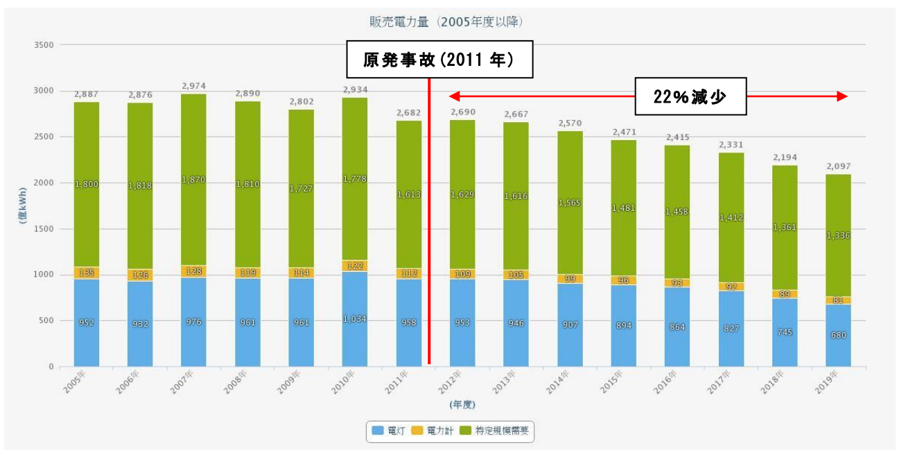
※図 3 (出典) 東電 WEB。東電管内の電力販売量は 3.11 後、2690 億 kWh/年→2097 億 kWh/年へ。
